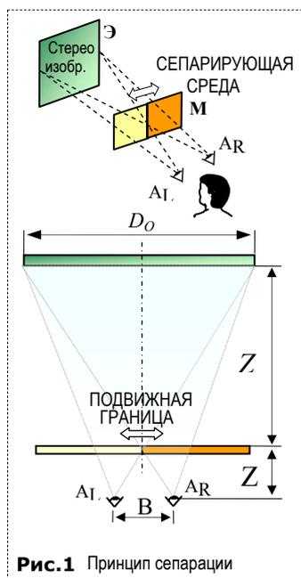
Рис.1 Принцип сепарации
